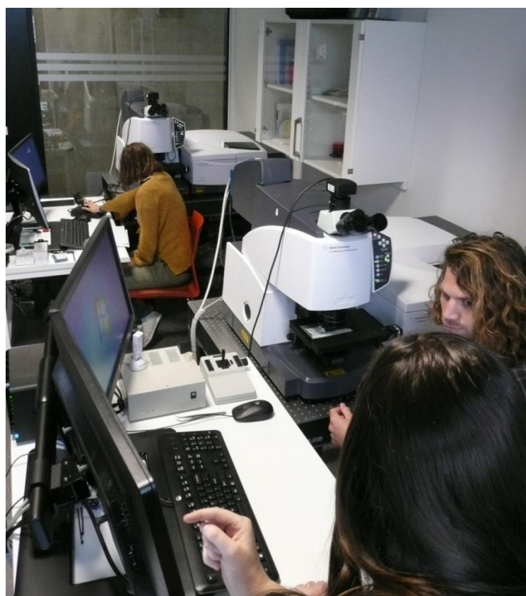
Figur 44. AAUs to Agilent Cary 620 FT-IR-mikroskoper hvert med 128x128 pixel FPA koblet til Agilent Cary 670 IR spektroskoper.
