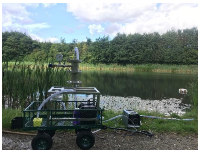
Figur 38. Udstyr til udtagning af vandprøver fra regnvandsbassiner.
