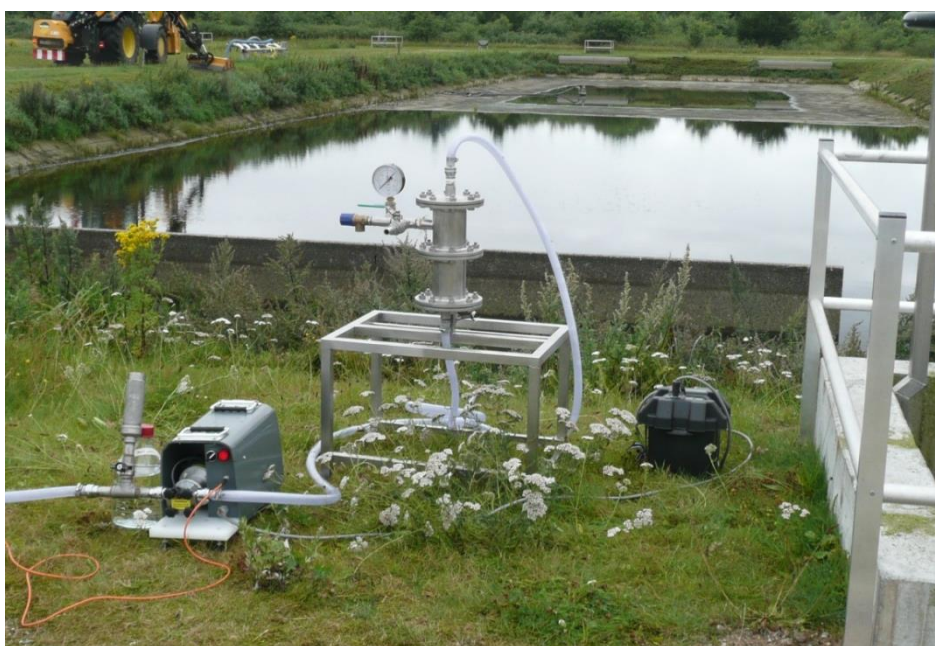
Figur 7. Filtersystemet anvendt ved prøvetagning på Renseanlæg B.
