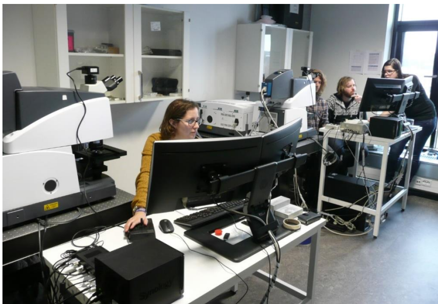
Figur 9. \mu\text{FTIR} imaging udstyr anvendt til mikroplast partikler <500\text{ }\mu\text{m} .
