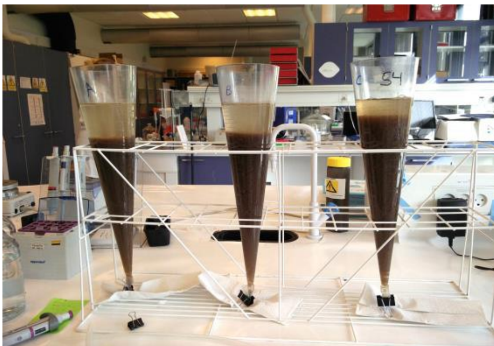
Figur 27. Forsøgsopsætning for lab-skala simulering af primær og sekundær klaringstank.
