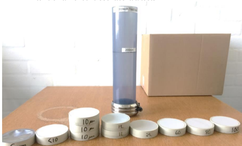
Figur 29. Hydrotech udstyr til test af membranfiltre.
